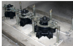
Stirnseitiges Schleifkopfma- gazin für sechs Schleifköpfe
