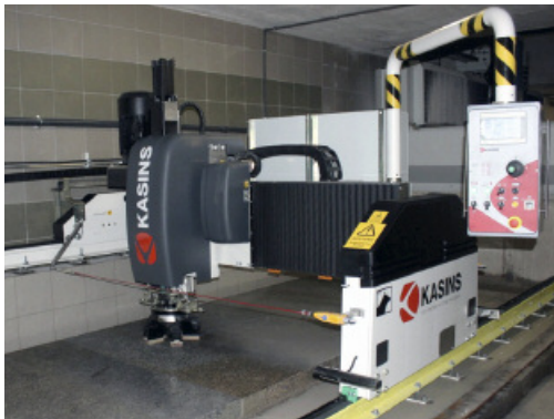
Stirnseitiges Schleifkopfma- gazin für sechs Schleifköpfe
